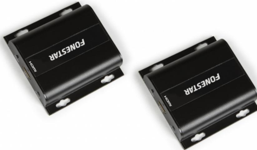
Extensión HDMI por cable Cat 5e/6 (transmisor y receptor) HDbiT. Compatible con Full HD 1080p/60Hz. Distancia de transmisión hasta 120 m con conexión directa para una resolución 1080p. Ampliable 120 m con cada nivel de switch. Conexión directa con cable cat 5e/6 o conexión a través de ethernet con switch. Función distribuidor a través de switch con múltiples receptores, hasta 253 receptores. Según norma IEEE-568B. Switch recomendado 1000 Mbps. Bajo consumo de ancho de banda 18 Mbps.
